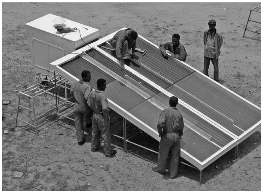
Durch ein eritreisches Unternehmen angefertigter Prototyp der vom Ökozentrum Langenbruck entwickelten Fruchttrocknungsanlage. Gekoppelt mit einem solaren Warmwasserspeicher kann die Anlage im 24-Stunden-Betrieb laufen (Bild: Ökozentrum Langenbruck).
